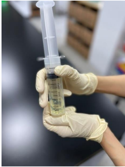
圖十三 迅速產生氯氣將活塞推開
