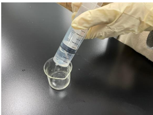
圖五 排除空氣及大部分水
